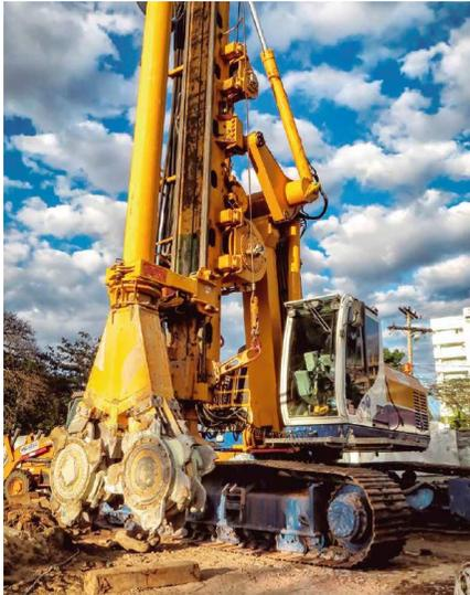
i. **Cutter Soil Mixing (CSM):** Sistema de pantalla de suelo cemento, completamente impermeable. El sistema constructivo permite altas productividades arriba de 120m<sup>2</sup> de muro por día.
